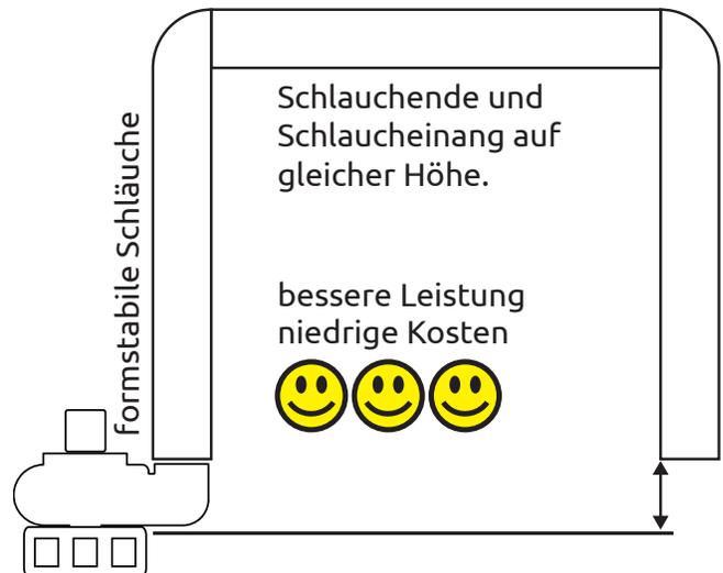
Platzieren Sie das Schlauchende unterhalb des Schlauchanfangs und Sie erhalten die maximale Leistung. Sobald der Schlauch mit Wasser gefüllt ist pumpt das System weiter auch wenn die Pumpe angehalten wird.
